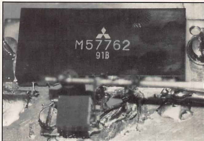
Photo 3 - Gros plan sur le câblage d'un hybride.
