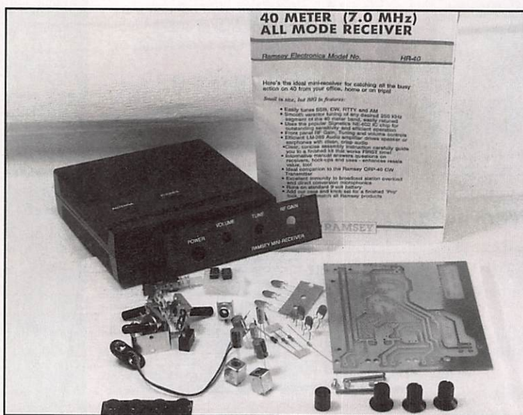
Les composants du kit et le boîtier.
