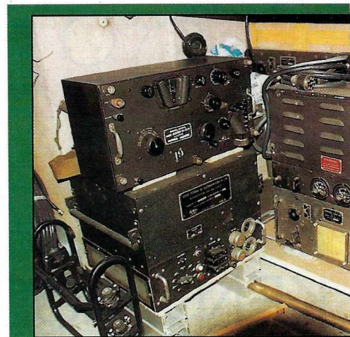
Emetteur BC-191 + alimentation secteur récepteur BC-312.
