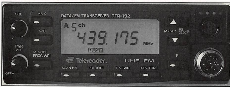
En haut à droite, la prise et les LED du TNC.
