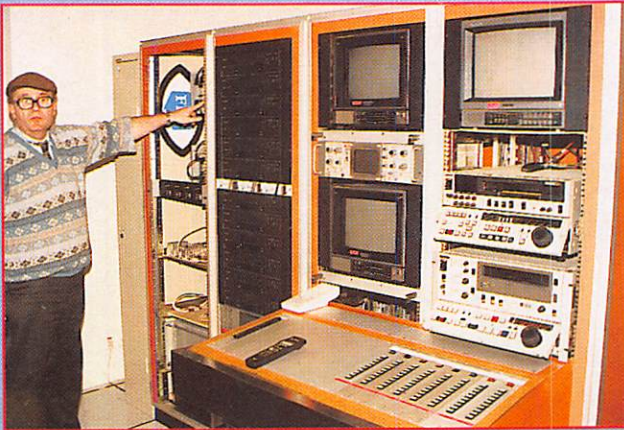
Banc de duplication VHS avec 12 magnétoscopes mis en place par F2LQ, notre guide.
