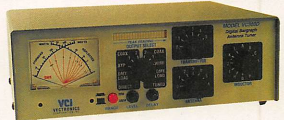
VC-300D BOITE D'ACCORD MANUELLE - 1,8 à 30 MHz - Puissance admissible : 300 W - Tos / Wattmètre, charge fictive, sélecteur d'antenne 6 positions. Lecture puissance crête avec baragraphe digital.
