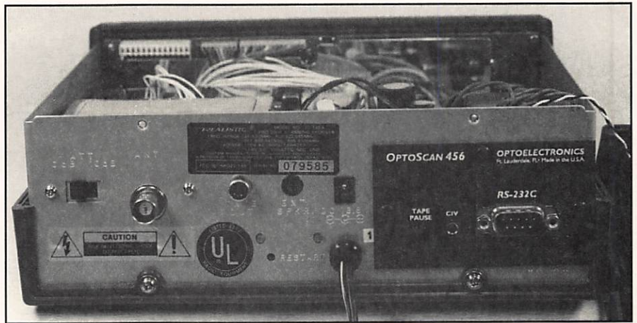
A l'arrière, on découvre la modification « OptoScan 456 ».
