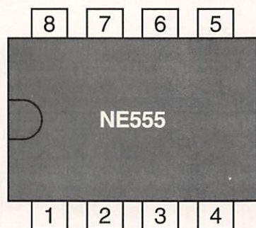
Figure 3b : Brochage du 555 (vue de dessus !).
