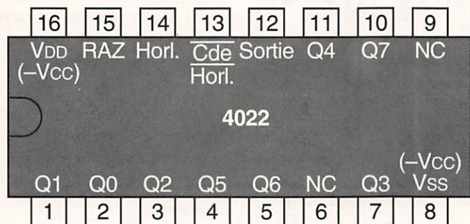
Figure 3a : Brochage du 4022 (vue de dessus !).
