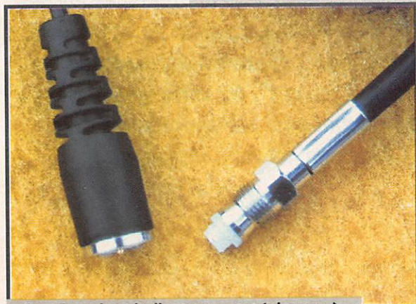
A g. la prise de l'antenne extérieure, à d. celle du portable.
