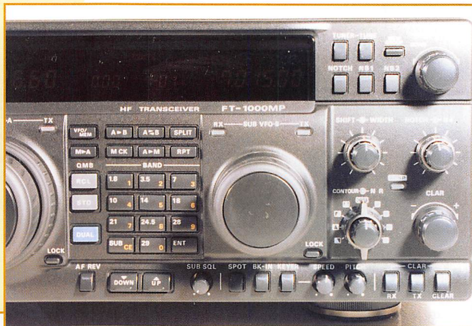
A droite du second VFO, la commande de l'EDSP.
