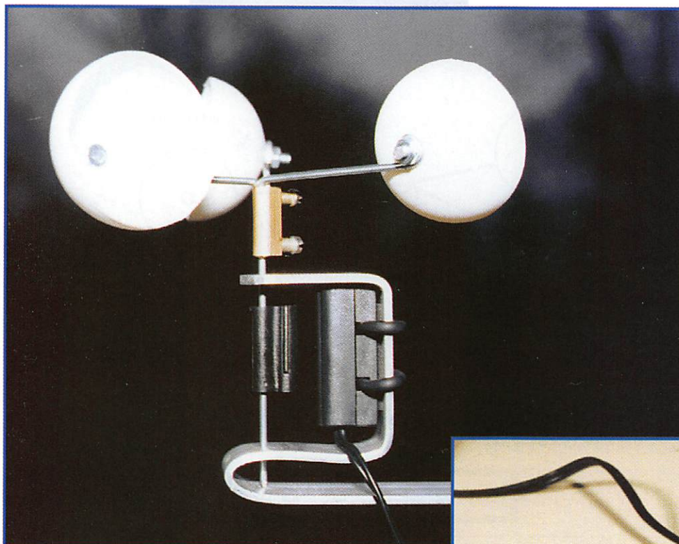
Le capteur et l'aimant. Les vis sur le domino seront sciées.
