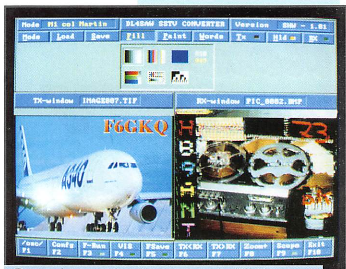
De nombreuses fonctions comme le "FILL" qui génère des mires.
