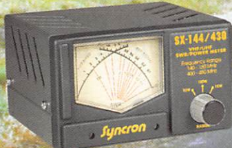
Wattmètre - Rosmètre SX 144/430 VHF + UHF Puissance : 1-10-1000 Watts
