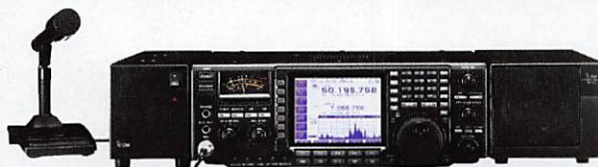
Photo du prototype présenté à l'homologation: IC-756 avec PS-85 (alimentation externe en option), SM-20 (micro de table en option) et SP-21 (HP externe en option).
