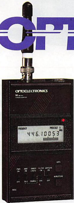
M-1 Fréquence portable. 20 Hz à 2,8 GHz
