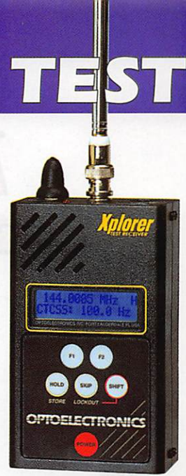
Captur d'émissions FM proches. XPLORER 30 MHz à 2,6 GHz. Caractéristiques du signal
