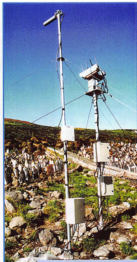
Vue partielle de l'installation : mât avec caméra et projecteur infra-rouge et mât avec antenne pour transmission de données.
