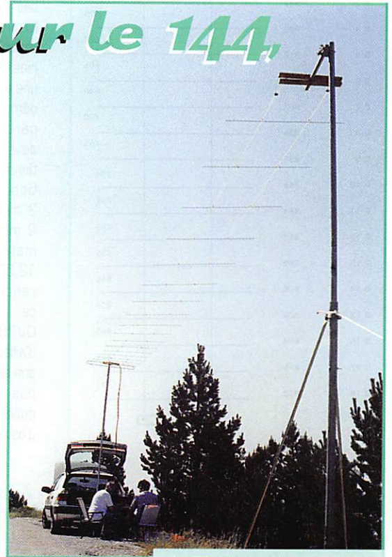
La "Yagi deux mètres déroulée" de F1DRN en ordre de marche. Le pointage se fait en déplaçant le côté opposé au trombone.
