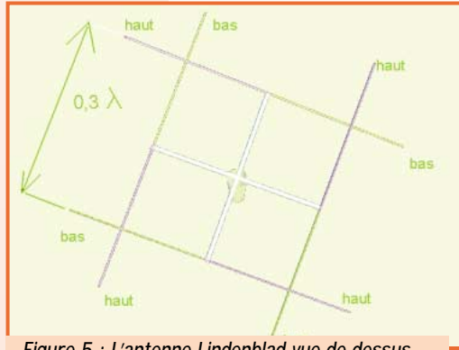
Figure 5 : L'antenne Lindenblad vue de dessus.
