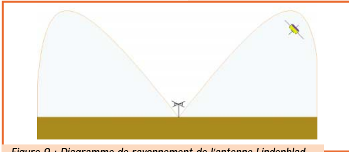
Figure 9 : Diagramme de rayonnement de l'antenne Lindenblad.
