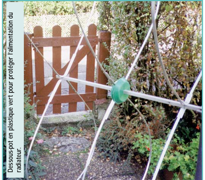
La pièce isolante alimentant le radiateur. Le câble passe à l'intérieur du boom flèche.
