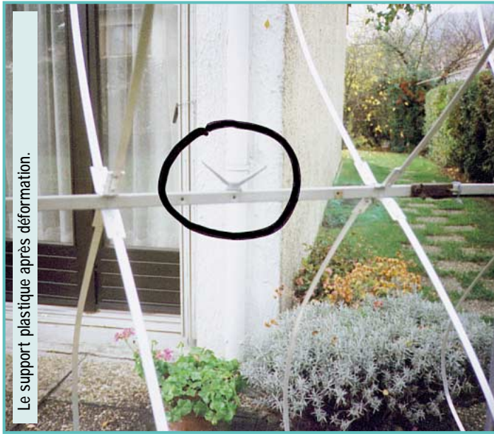
La pièce isolante alimentant le radiateur. Le câble passe à l'intérieur du boom flèche.
