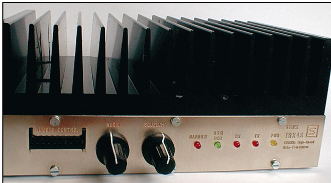
Face avant du TRX4S, avec contrôle du volume et du niveau de squelch, LED d'état.
