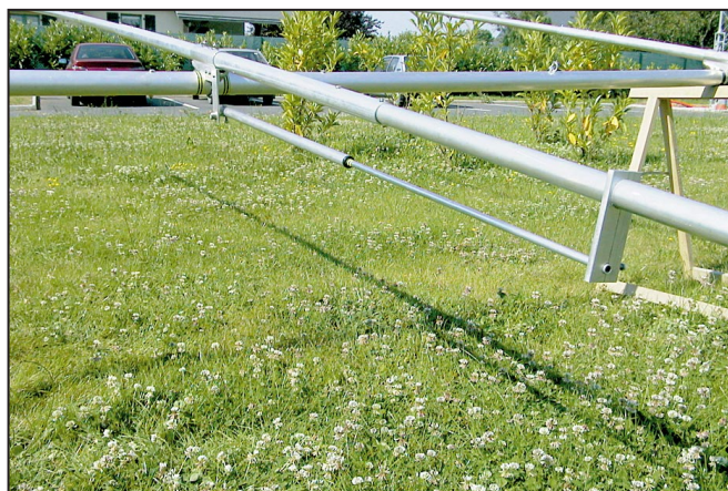
▲ Le gamma-match. ▼ Deux points de fixation c'est mieux qu'un seul !
