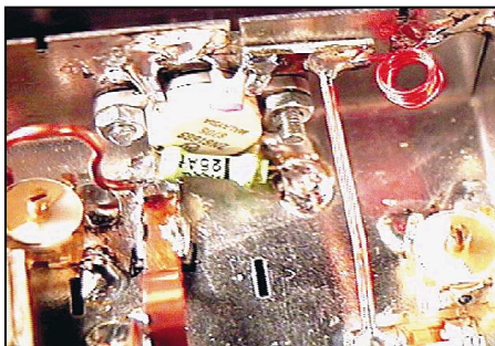
Photo 6 : Le transistor est fixé sur le petit côté du boîtier pour assurer une bonne évacuation de la chaleur.
