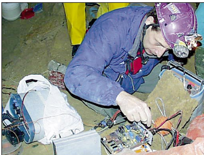
F6EAJ Didier de l'ADRASEC 38, avec l'émetteur-récepteur Nicola sur 87 kHz qu'il a construit. Encore plus petit et plus performant. Sur la gauche de la photo, on peut voir le Nicola qui a participé aux essais à la cote moins 1000 mètres au Gouffre Berger.
