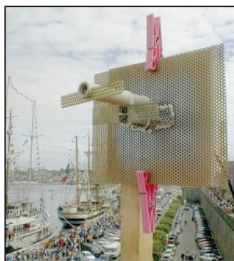
Antenne panneau 1,2 GHz, conception F1CCP.
