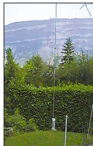
Figure 13 : L'horizon chez HB9SLV, une vraie catastrophe pour le DX !
