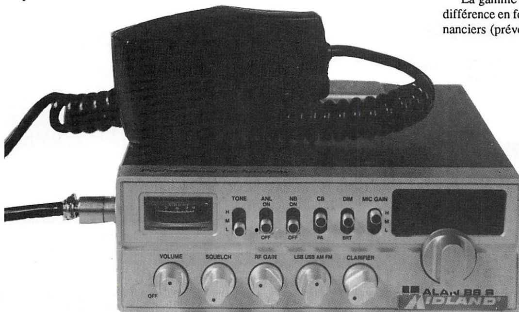
Un émetteur-récepteur CB très complet, offrant les 3 modes de modulation : AM, FM, BLU mais extrêmement simple à manipuler.
