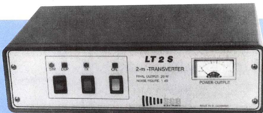
Le transverter, un appareil qui permet de trafiquer en VHF avec les performances du matériel décimétrique.
