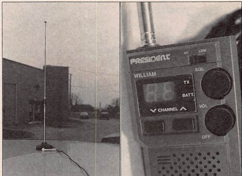
Montage rapide sur le toit
