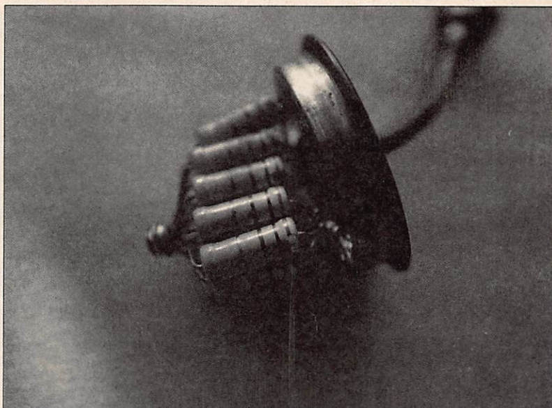
Les soudures coté boîtier.
