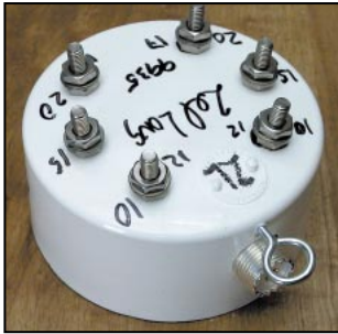
Le balun spécial (non utilisé ici).
