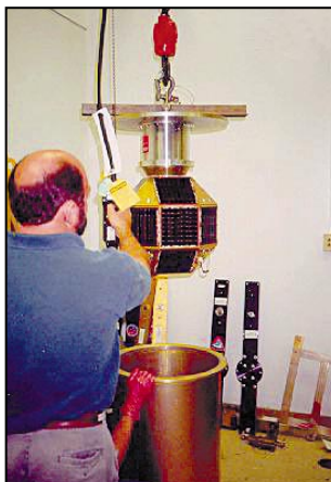
PANSAT en cours de montage.
