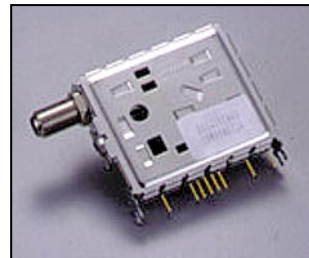
Module tuner Comtech.
