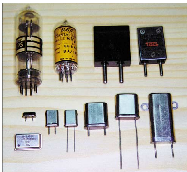
Figure 2 - Divers types de boîtiers de quartz.
