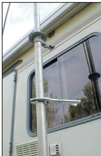
La pince étau pour tourner l'antenne.
