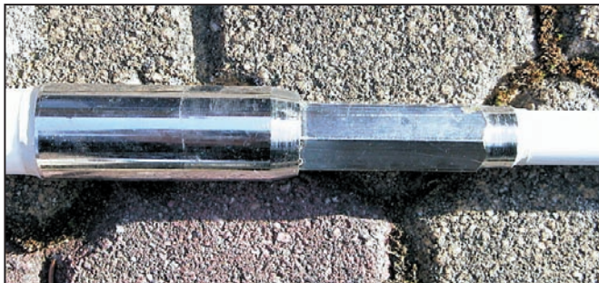
La jointure entre deux brins.
