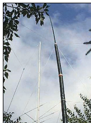
L'antenne verticale hélicoïdale de HB9ASB.
