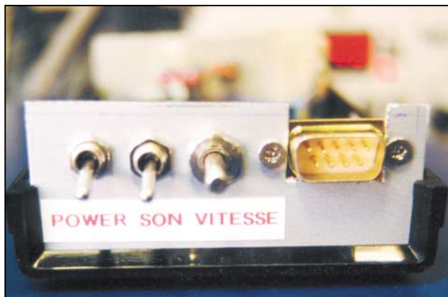
Vue de la face arrière, avec de gauche à droite : le bouton de mise en marche, la commande de mise en fonction du buzzer, le réglage de la vitesse de transmission et la prise DB9 de raccordement.
