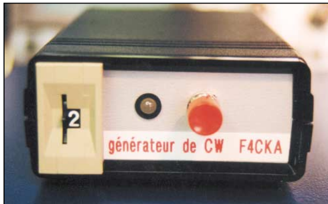
Le boîtier vu côté face avant, avec de gauche à droite : la roue codeuse, la LED témoin et la commande d'envoi de message.
