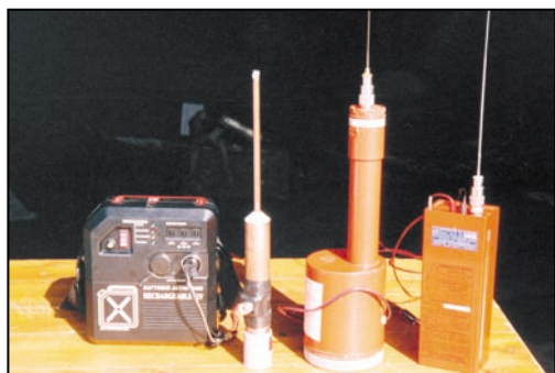
Balises, antenne « faite maison » 70 cm et batterie autonome.
