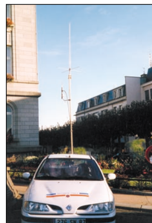
Antennes VHF et UHF érigées sur un mât fixé à l'attache-caravane de la voiture.
