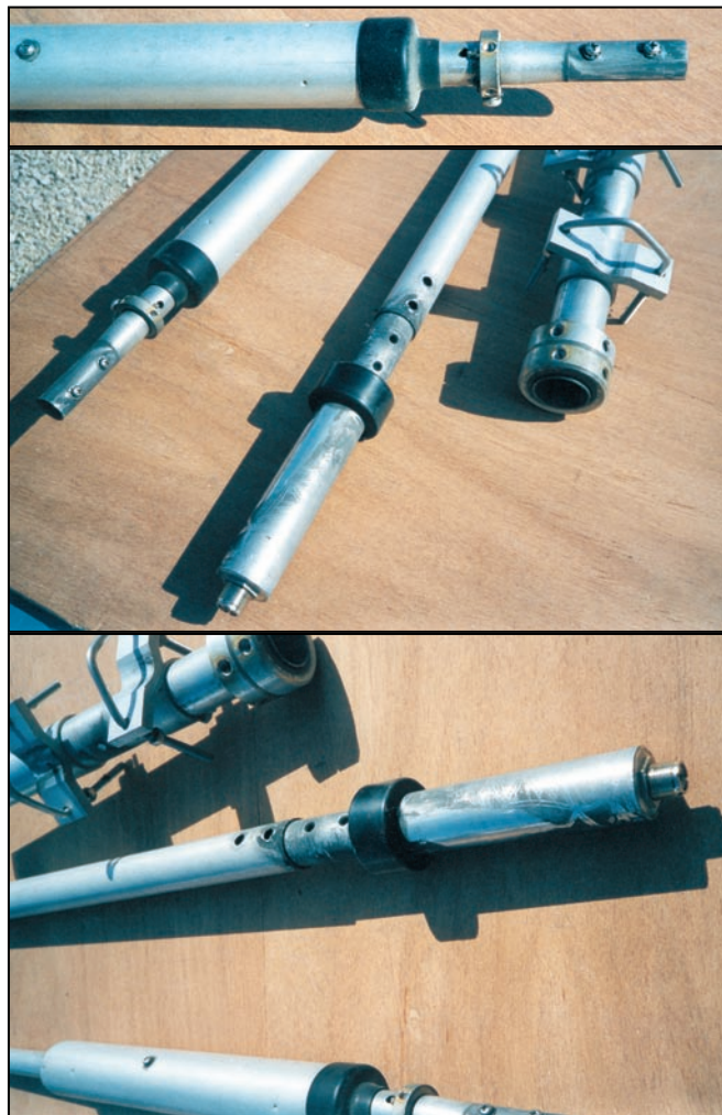
Voici un démontage d'antenne après 2 années de service. On remarquera le niveau important d'oxydation sur les éléments actifs. C'est le siège de M.C.C.E.
