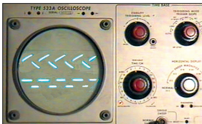
Photo 1: Les signaux observés sur les pattes du circuit intégré.
