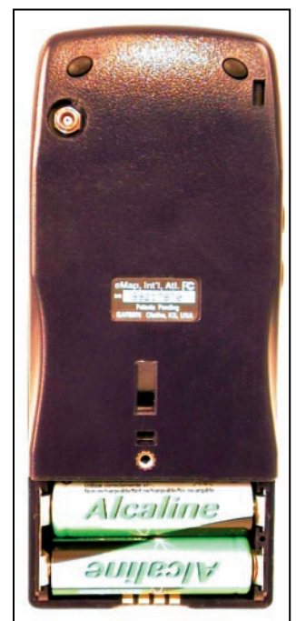
Au dos de l'eMap, la prise antenne extérieure.
