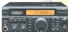
FT-840 Emetteur/récepteur HF base/mobile 100 W
