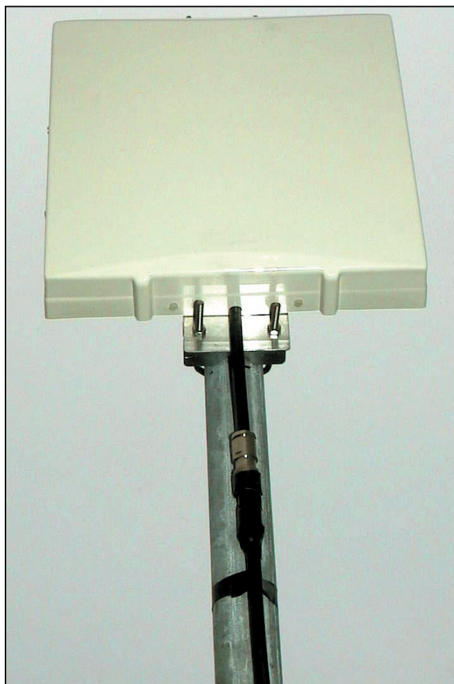
L'antenne patch est discrète et offre une prise au vent relativement réduite.
