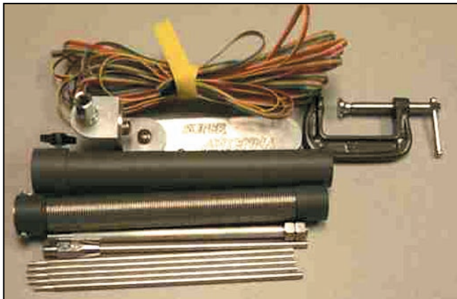
Antenne démontable de faible encombrement.
