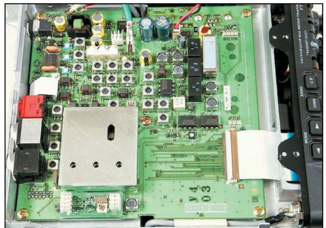
Une vue de l'intérieur (près du panneau avant, l'emplacement du filtre optionnel).
