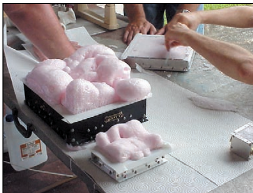
Protection de modules par mousse polyuréthane.
