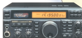
FT-840 Emetteur/récepteur HF base/mobile 100 W
