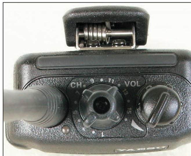
Cette vue de dessus montre le sélecteur de canaux.
