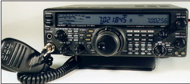
Un émetteur-récepteur couvrant HF, VHF et UHF.
