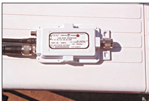
Photo 5 : Préalimentateur à large bande.
