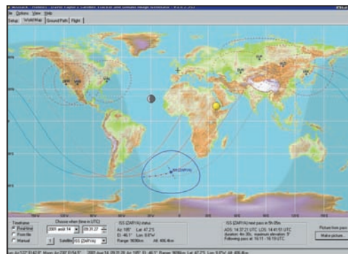
WXTRACK : Planisphère avec tracé des orbites et représentation des stations sol. WXTRACK : Passage d'un NOAA : image réelle à droite.
