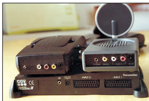
Photo 2 : Diverses connectiques : le Technisat, le Thomson (parmi les meilleurs), le CGV (parmi les moins bons).
