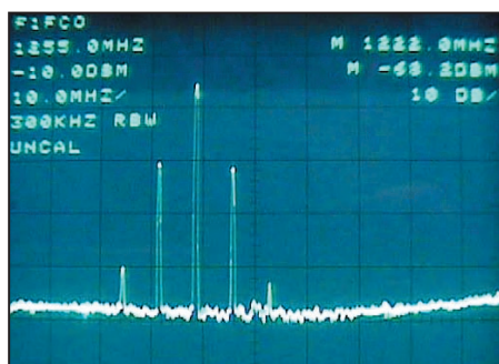
Photo 8 : Sous-porteuse son 6,5 MHz à -16 dB de la porteuse principale.
