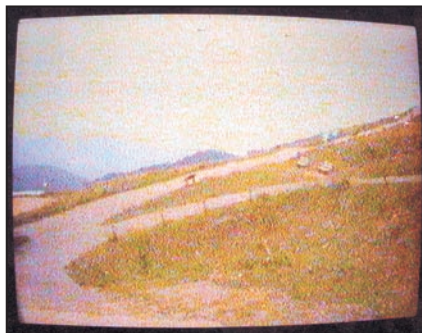
Photo 17-4 : Avec démodulateur et F = 1,5 dB, sans "DNR". Via démodulateur satellite.
