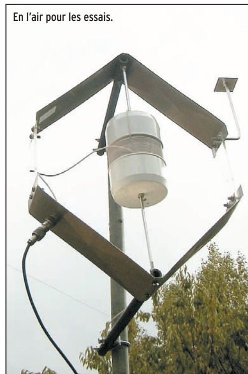
Vue de l'antenne assemblée, dispositif de réglage monté.
