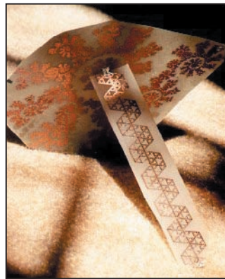
Figure 19 : Un monopôle à très large bande, combinant des spirales fractales et un ruban fait de triangles de Sierpinski. Nathan Cohen NIIR.
