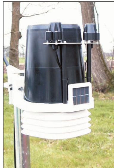
L'ISS support des capteurs. Notez le petit panneau solaire.
