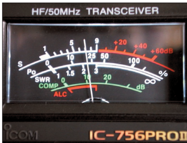
Un Smètre calibré à 3 dB par point.
