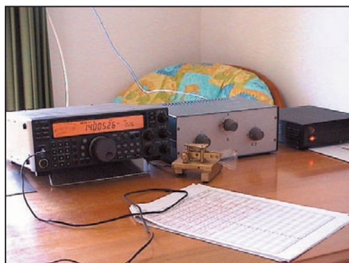
La station : un TS-570 et un coupleur d'antenne.
