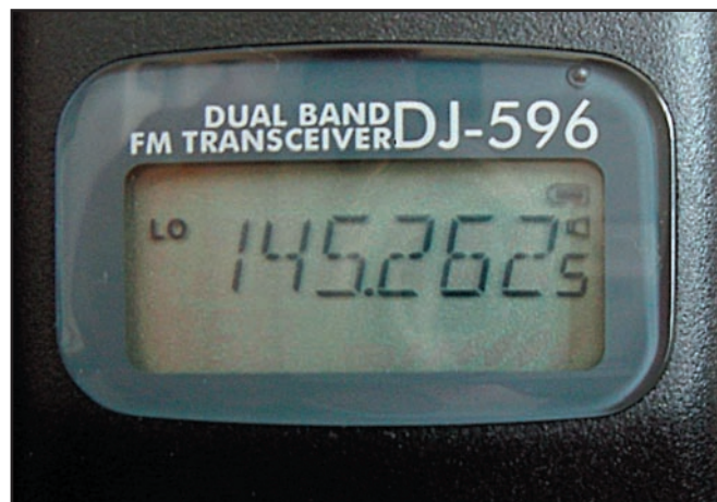
Photo 5: L'icône haut-parleur apparaît sur le LCD en mode numérique.
