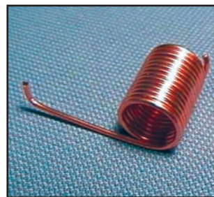
Figure 7: "La bobine à spires jointives terminée".
