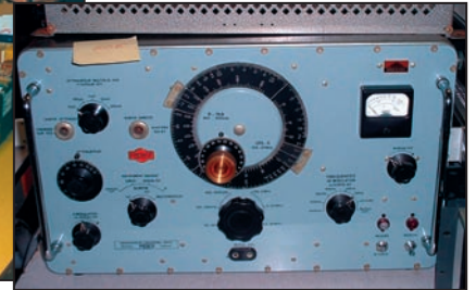
Photo 5 : Un générateur universel
