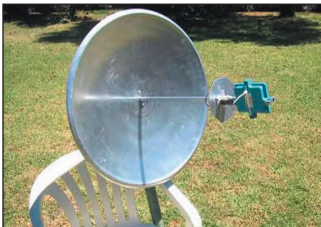
Figure 6 : Antenne parabolique avec Drake pour réception AO-40.
