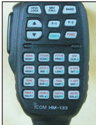
Photo 4: Le micro permet de contrôler la plupart des fonctions de l'appareil.
