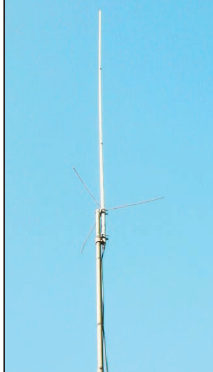
Photo 4: Une antenne verticale "colinéaire".
