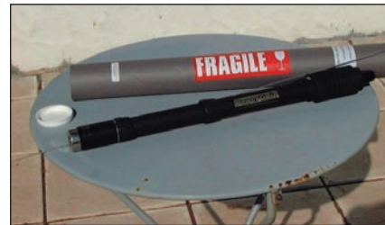
7 - L'embase de l'antenne ATAS-100 avec les radians.
