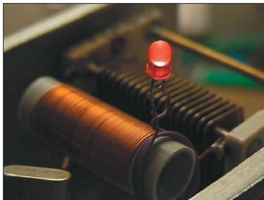
figure 3: Une boucle de Hertz avec une LED.
