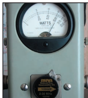
8 - Bouchon 1 kW sur le Bird, 680 W mesurés en 28 MHz.
