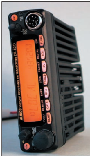
2 - Le panneau avant peut-être retourné de 180 degrés.
