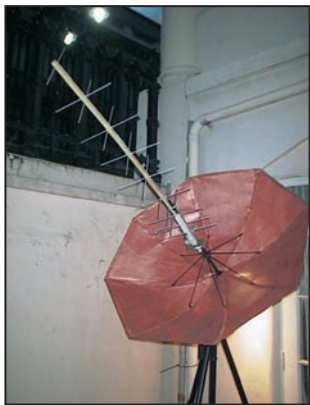
1 - Antenne parapluie de G6LVB, dépliée.
