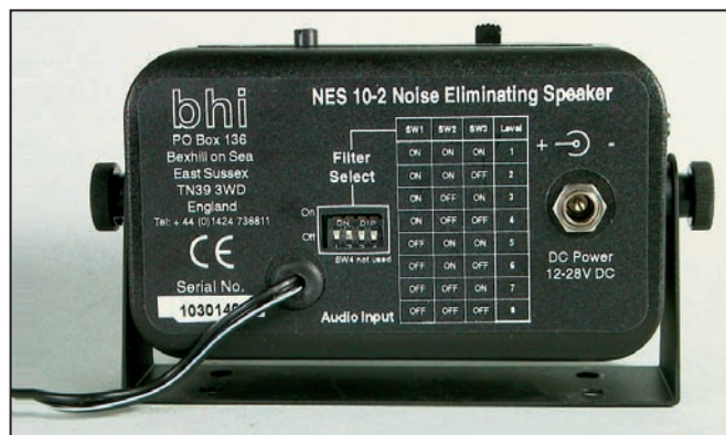
5 - Le réglage du niveau de réduction se fait à l'aide d'un DIP-switch.
