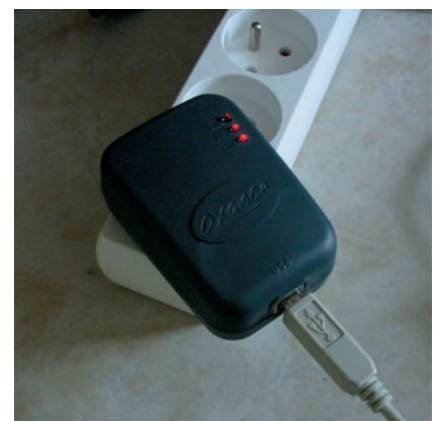
2 - Boîtier modem CPL Oxance en fonctionnement.
