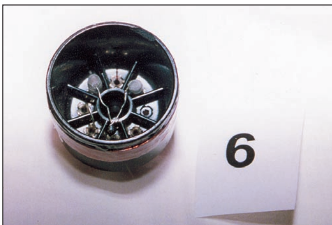
6 - Bobinage avec les deux capas Cc supplémentaires.
