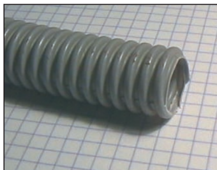
Figure 2: Gaine électrique annelée pour faire des supports.
