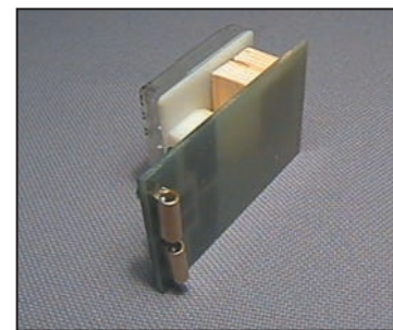
Photo 5: Les deux contacts de mesure qui viendront frotter sur la ligne.
