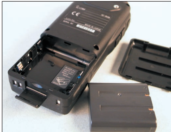
3 - La batterie peut être remplacée par 3 piles AA.
