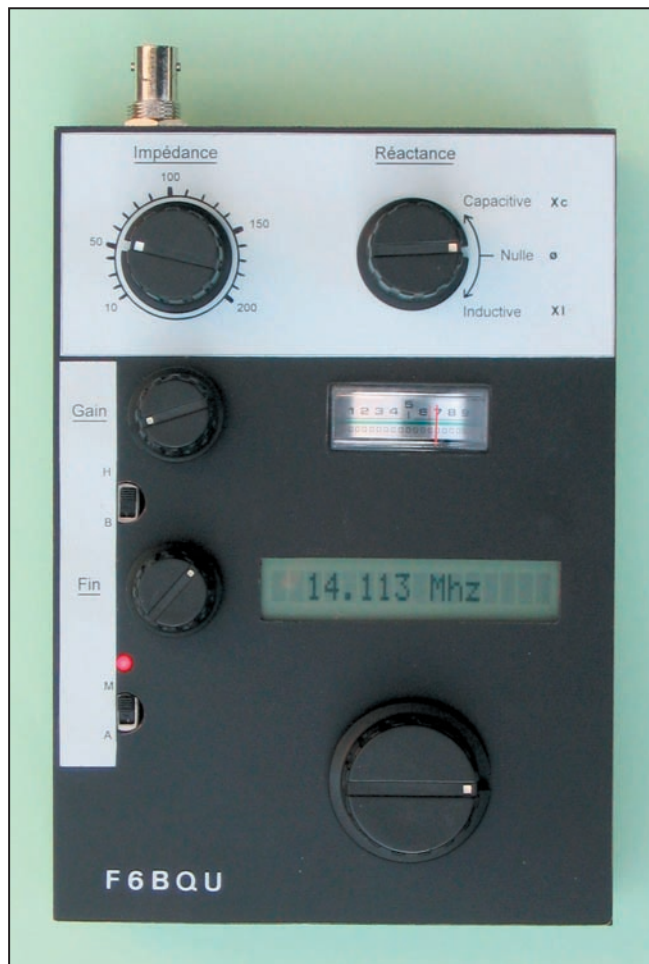
Figure 6 : L'analyseur d'antennes terminé
