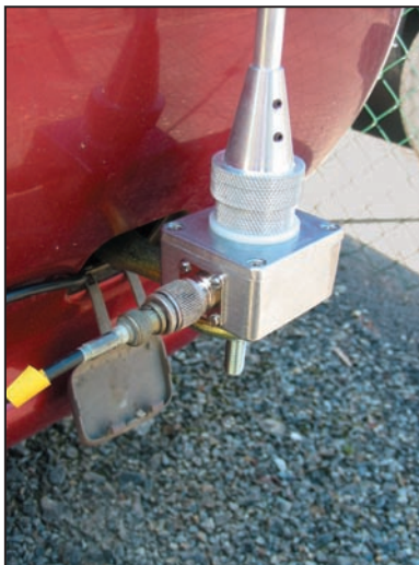
3 - Mise en place de l'embase de l'antenne.
