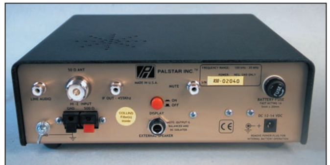
5 - Le panneau arrière. Notez la présence de la sortie FI...
