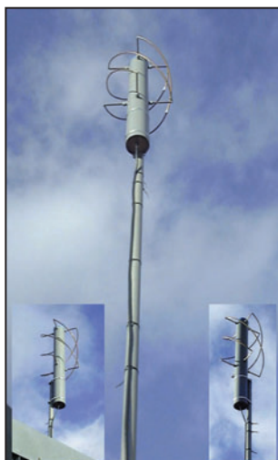
Fig. 11 - Vue générale des antennes Quadrifillar Helix (GOHPO).
