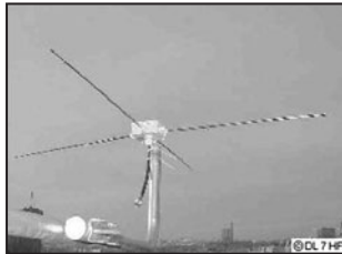
Fig. 6 - Antenne Turnstile (a).
