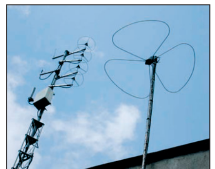
2 - Les antennes du transpondeur linéaire de FIEE.
